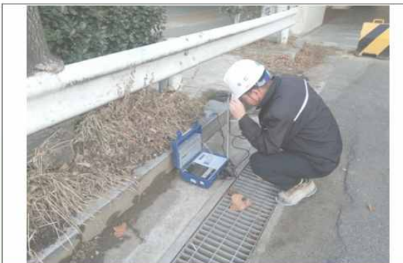
발파 시 계측 측정 (성내천)
